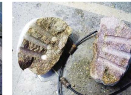
Разрушение объекта из гранита по заданной линии раскола при двухканальном воздействии.
