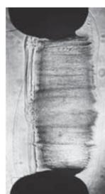
Разряд приводит к образованию плазменного шнура, который расширяется со скоростью 1410 м/с. Ограниченные жидкостью пар и плазма образуют полость, представляющую собой кавитационный пузырь. Этот пузырь растет до максимального размера и через несколько сотен микросекунд схлопывается.
