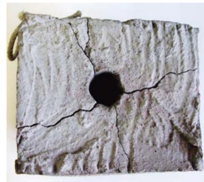
Радиально-симметричное разрушение объекта из бетона при одноканальном воздействии.
