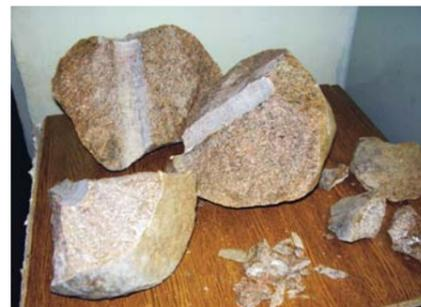
При одноканальном воздействии на объект из камня или горных пород наблюдается радиальное развитие трещин и раскалывание объекта на три или более фрагментов.
