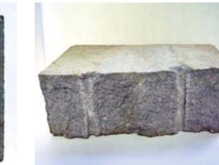
При двухканальном воздействии на объект из камня или горных пород наблюдается раскалывание объекта только на два фрагмента по линии, задаваемой пробуренными шпурами.
